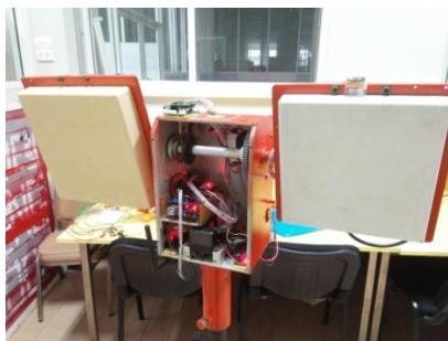
รูปที่ 7 เสาอากาศติดตามอากาศยานไร้คนขับอัตโนมัติด้านหน้า
