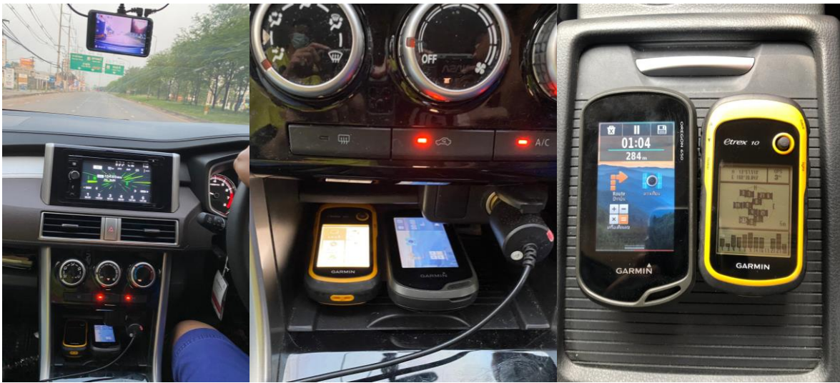
รูปที่ 3.3-14 การขับรถสำรวจความเร็วในการเดินทางด้วยวิธี Floating Car โดยใช้ GPS
