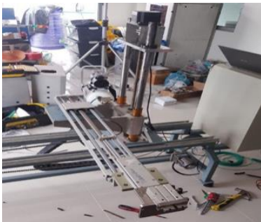
รูปที่ 8 การสร้างตัวหุ่นยนต์ต่อเข้ากับวาล์วลม 5/2 เข้ากับตัวหุ่นยนต์
