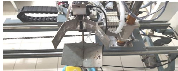
รูปที่ 25 การติดตั้ง Gripper
