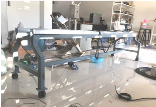
รูปที่ 23 การประกอบรางเลื่อนและล้อ
