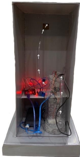
ภาพที่ 6 ทดลองการทำงานของตัวเซ็นเซอร์ตรวจจับวัตถุสิ่งกีดขวางอินฟราเรด ไออาร์
