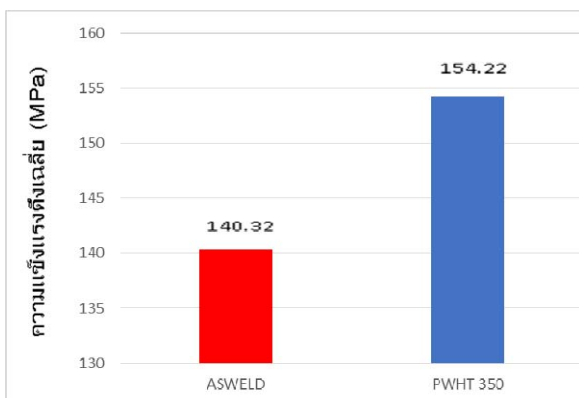
ภาพที่ 7 กราฟเปรียบเทียบระหว่างชิ้นงานอบและไม่อบ
