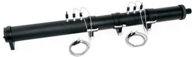
รูปที่ 4 ลักษณะของ Impedance Tube B&K 4206 สำหรับตรวจวัดชิ้นงานขนาด 100 mm
