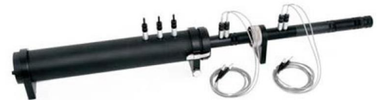
ภาพที่ 5 ลักษณะของ Impedance Tube B&K 4206 และ Transmission Loss Tube UA-1630 สำหรับตรวจวัดชิ้นงานขนาด 30 mm
