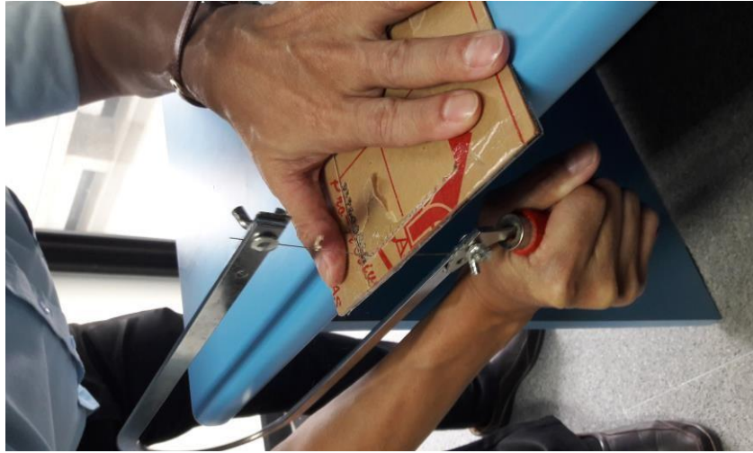
ภาพที่ 3 ตัดกรอบแผ่นพลาสติกแบบอะคริลิก (Acrylic)
