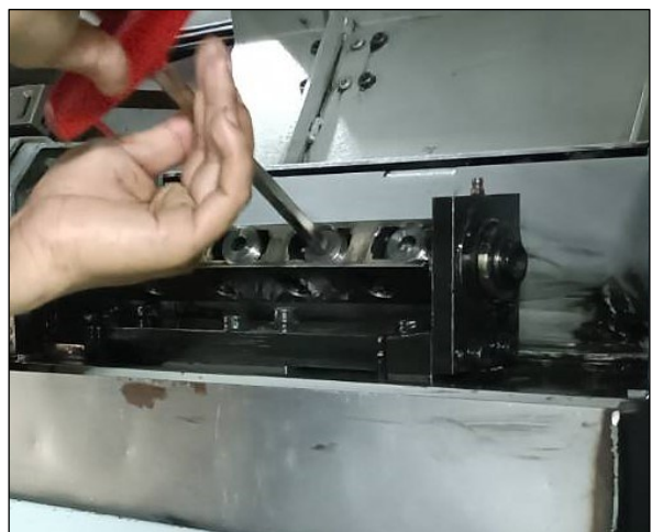
ภาพที่ 7 การประกอบแม่พิมพ์รีดลวดสปริงเข้ากับชุดแกนหมุน
