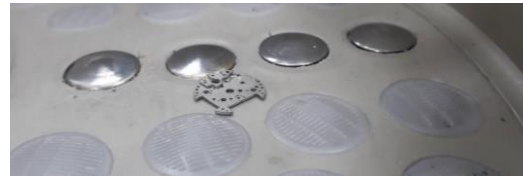
รูปที่ 7 แท่งตัวนำไฟฟ้าที่ออกแบบใหม่ และตาข่ายพลาสติกประกอบเข้ากับตะกร้าใส่ชิ้นงาน
