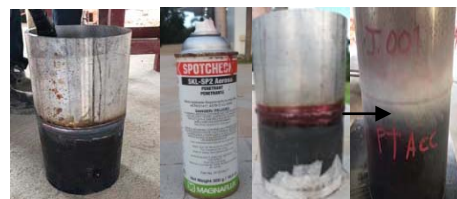
รูปที่ 3 การลงน้ำยาเพื่อตรวจสอบรอยแตกในแนวเชื่อม
