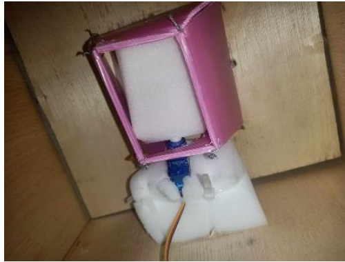
ภาพที่ 4 ตำแหน่งติดตั้ง Servo Motor ที่ใช้ทำหน้าที่ปล่อยอาหาร เมื่อกดปล่อยให้อาหารในแอปพลิเคชัน Blynk เซนเซอร์จะทำงานปล่อยอาหารลงถ้วยอาหาร
