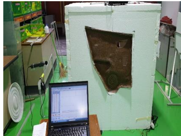
รูปที่ 6 ติดตั้งแผงบุผนังประตูรถยนต์เข้ากับห้องจำลองโดยสารรถยนต์
