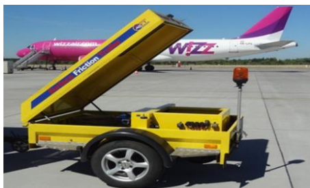
รูปที่ 2 เครื่องทดสอบวัดค่าแรงเสียดทาน Airport surface friction tester T-10 [7]
