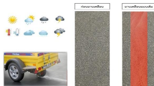
รูปที่ 3 การฉาบเคลือบวัสดุเพิ่มแรงเสียดทาน (จัดทำโดยคณะผู้ศึกษา)
