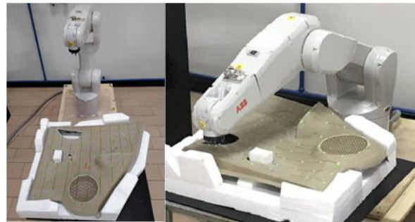
รูปที่ 6 ทดสอบการวัดแผ่นกันเสียงประตูดรถยนต์โดยแขนกลอัตโนมัติ
