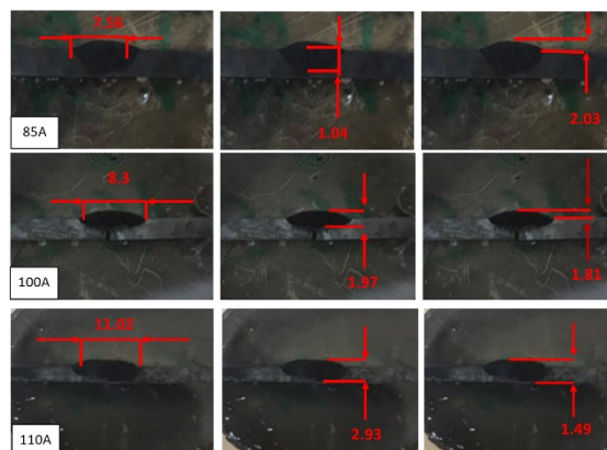
ภาพที่ 6 ตัวอย่างระยะเวลาหลอมละลายของแนวเชื่อม
