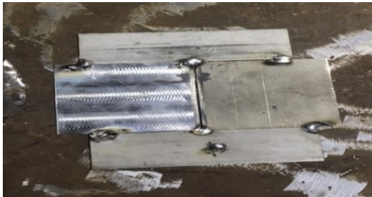
ภาพที่ 2 ลักษณะการยึดชิ้นงานก่อนเชื่อม
