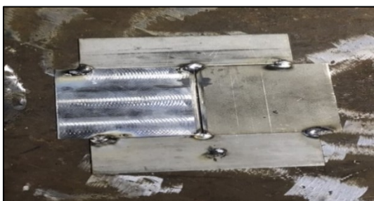
ภาพที่ 2 แสดงลักษณะการยึดชิ้นงานก่อนเชื่อม
