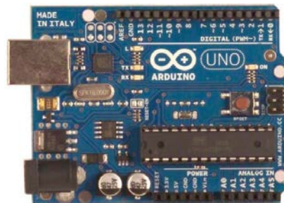
รูปที่ 1 บอร์ดไมโครคอนโทรลเลอร์ Arduino UNO R3 [3]
