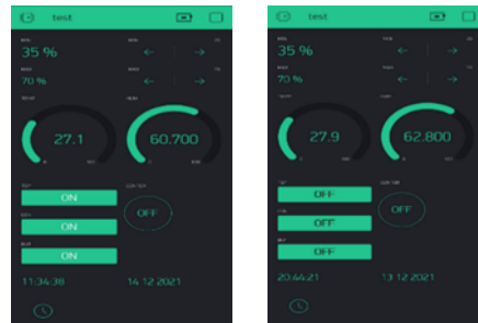
ภาพที่ 2.3 แสดงระบบควบคุมระบบโรงเรือนด้วย Application Blynk ผ่านมือถือ
