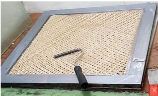
รูปที่ 4 นำแผ่นใยไฟเบอร์ที่ตัดเสร็จมาวางในแม่พิมพ์
