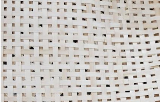
รูปที่ 2 แผ่นใยไฟเบอร์ที่ผ่านการทอ 2 มิติ
