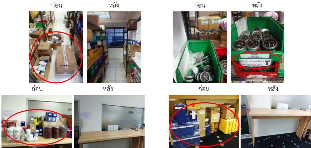
รูปที่ 6 การกำหนดตำแหน่งพื้นที่จัดเก็บและจัดเรียงสินค้าใหม่ตามหลัก ABC ด้วยเทคนิค AHP ควบคุมหลัก FIFO ที่มา: ผู้จัดทำ
