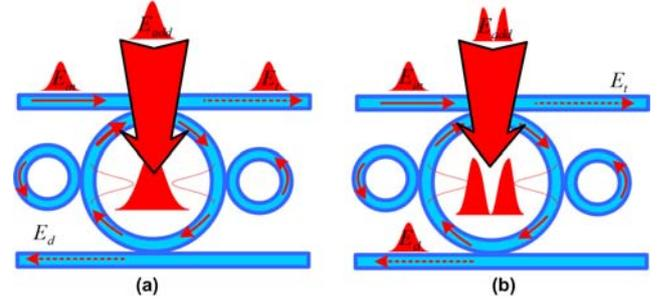
FIG.4 DARK-BRIGHT NONLINEAR CONTROL SWITCH
