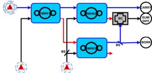
**FIG. 7** ALL-OPTICAL HALF ADDER/SUBTRACTOR
