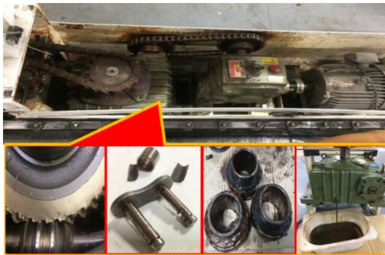
รูปที่ 4 ตัวอย่างปัญหาชุดเกียร์สายการผลิตหยุดนอกแผนการซ่อมบำรุง
