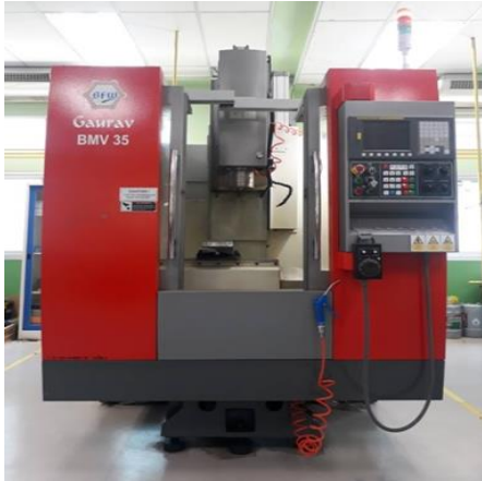
รูปที่ 1 เครื่องกัดอัตโนมัติยี่ห้อ BFW Gaurav รุ่น BMV 35 คอนโทรล Fanuc Series Oi-MD [9]
