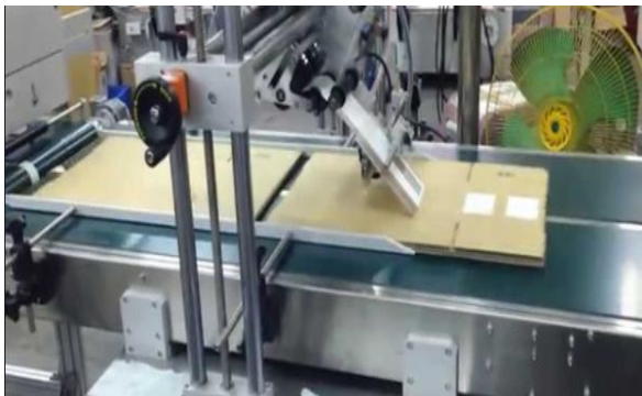
รูปที่4 เครื่องติดฉลากกล่องอัตโนมัติเพื่อใช้ในการลดปัญหาการเกิดคอ ขวด [10]
