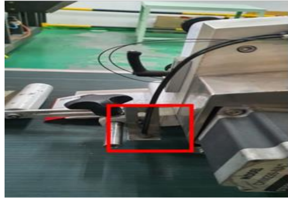
รูปที่ 5 ตำแหน่ง sensor ของเครื่องติดฉลากกล่อง [5]
