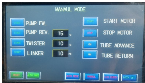
(ก) หน้าจอทัชสกรีนแสดงอยู่ในหน้าหน้าควบคุมด้วยมือ (Manual mode)
