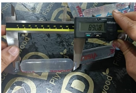
ภาพที่ 12 การวัดขนาดความยาวของลูกไส้กรอก 90 \pm 20 มิลลิเมตร
