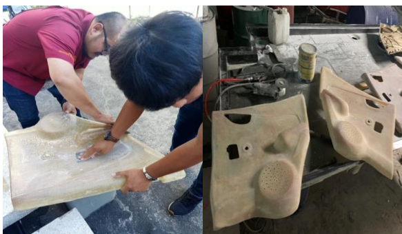
รูปที่ 5 การขัดชิ้นงานด้วยกระดาษทราย และการเจียร์ ตกแต่ง
