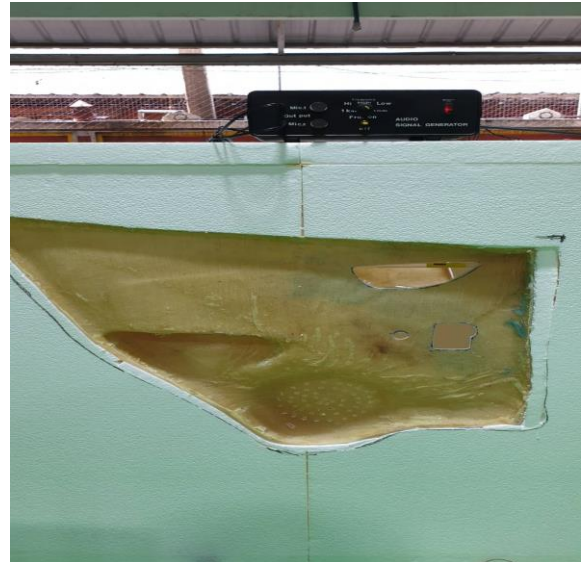
รูปที่ 6 การติดตั้งแผ่นแผงบุผนังประตูรถยนต์เข้ากับห้องจำลองห้อง โดยสารรถยนต์
