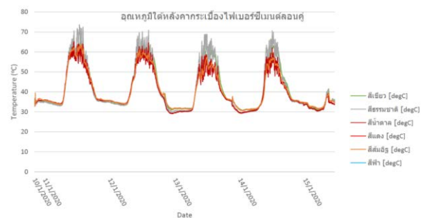
รูปที่ 8 ผลการทดสอบอุณหภูมิใต้หลังคา
