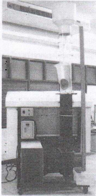
รูปที่ 11 ชุดทดลองฟลูอิดไดซ์เบดหลังจากเพิ่มชุดลำเลียงอัตโนมัติแบบต่อเนื่อง
