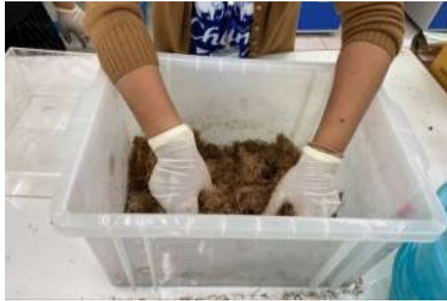
ภาพที่ 4 การผสมคลุกเคล้าเส้นใยกับน้ำยางธรรมชาติ
