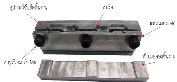
ภาพที่ 11 องค์ประกอบของอุปกรณ์จับยึดชิ้นงาน
