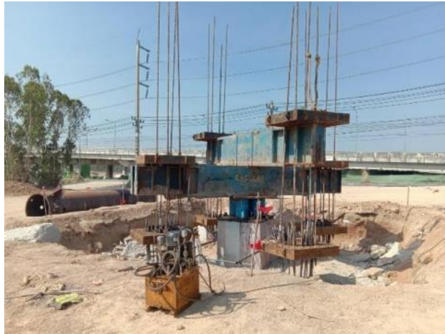
รูปที่ 3 การทดสอบการรับน้ำหนักของเสาเข็ม ที่มา: บริษัทแคสแลบ(ประเทศไทย) จำกัด (2564)
