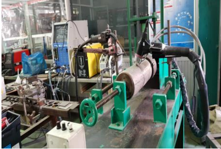
รูปที่ 2 แสดงการเชื่อมชิ้นงานด้วยอาร์คพลาสมา
