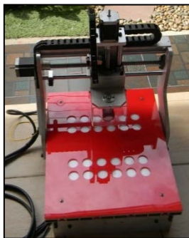
รูปที่ 9 โครงสร้างชุดฝึกหุ่นยนต์แบบคาร์ทีเซียน, หัวจับแม่เหล็ก และช่องวางตำแหน่งงาน
