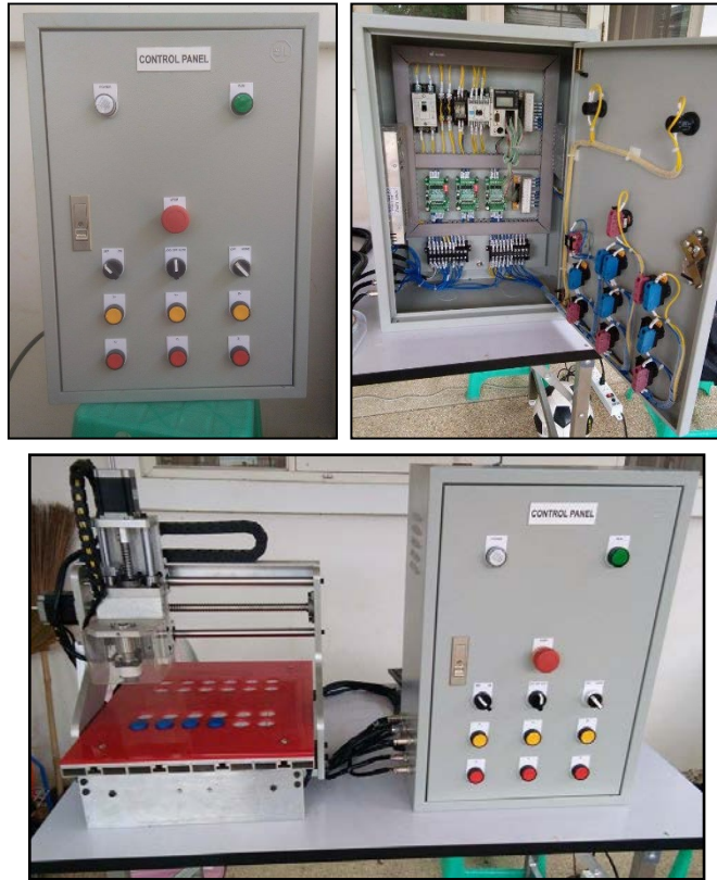
รูปที่ 11 ตู้ชุดควบคุมหุ่นยนต์แบบคาร์ทีเซียนด้านนอก ด้านในและที่ประกอบกันอย่างสมบูรณ์
