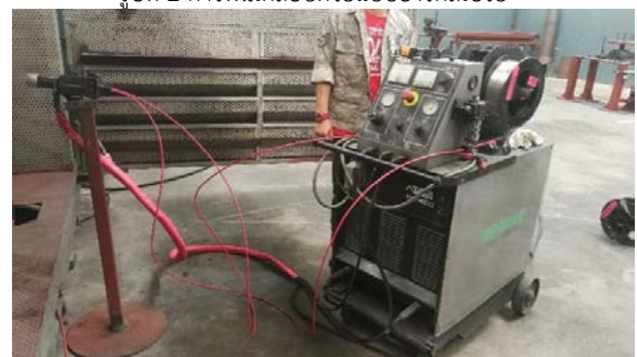
รูปที่ 3 เครื่องพ่นเคลือบแบบอาร์คสเปรย์ รุ่น Tafa 400
