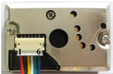
รูปที่ 2 Sharp GP2Y1010AU0F Optical Dust Sensor
