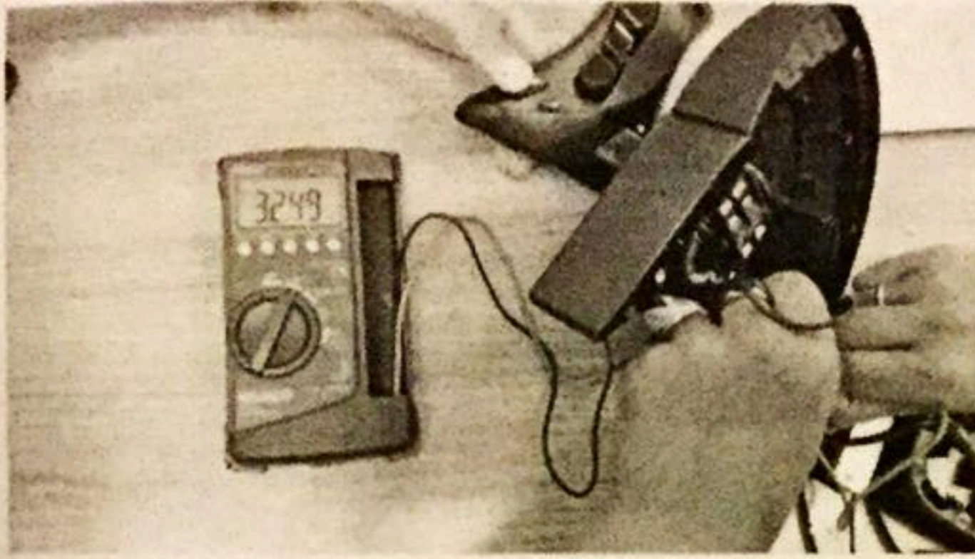
รูปที่ 7 แรงดันไฟฟ้าถูกส่งมา 3.2 V Dc. ณ ตำแหน่ง คันเร่งระดับต่ำสุด
