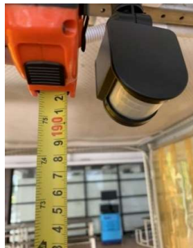
รูปที่ 14 ระยะความสูงจากพื้นถึงตัวเซนเซอร์ 191 cm.
