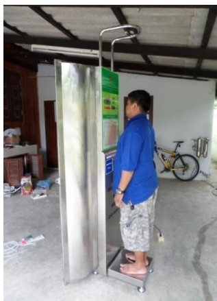
ภาพที่ 5 การทดสอบสมรรถนะเครื่องชั่งน้ำหนักคำนวณค่าดัชนีมวลกาย
