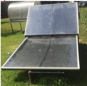
ภาพที่ 1 ตู้อบแห้งพลังงานแสงอาทิตย์ชนิดลมร้อน
