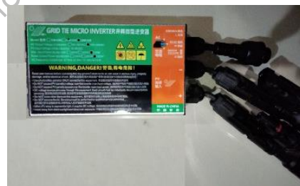
ภาพที่ 2 เครื่องแปลงกระแสไฟฟ้าระบบ Grid connected inverter รุ่น GMI 350
