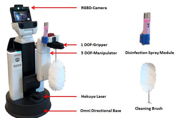
ภาพที่8 หุ่นยนต์ทำความสะอาด [18] หรืออาจเป็นการใช้หุ่นยนต์ที่มีการติดตั้งหลอดไฟUVC เพื่อการทำความสะอาดฆ่าเชื้อในห้องพัก โดยหุ่นยนต์ได้มีการ
