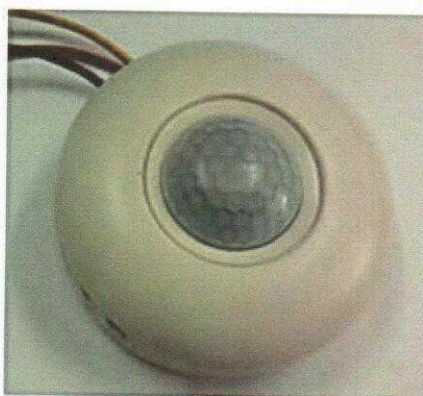
ภาพที่ 14 อุปกรณ์ตรวจจับ Motion Sensor เพื่อควบคุมการทำงานของระบบแสงสว่าง [12]
