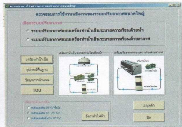
รูปที่ 11 หน้าจอตรวจสอบเลือกระบบปรับอากาศเพื่อสั่ง การควบคุมด้วยระบบการจัดการพลังงาน
