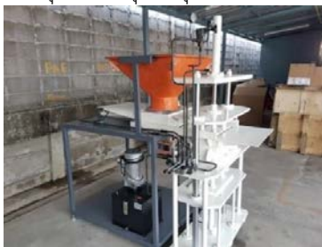
รูปที่ 7 การประกอบระบบไฮดรอลิก และโครงสร้างเครื่องอัดคอนกรีตบล็อก
