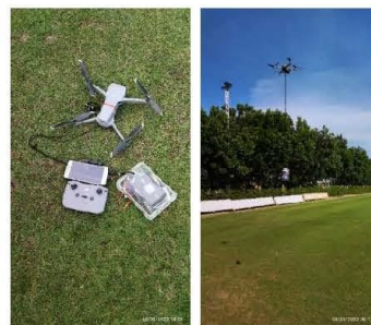
รูปที่ 9 ชุดควบคุมการบิน MiniPix และชุดควบคุมการรับ-ส่งข้อมูลการบินที่ถูกหิ้วขึ้นไปกับโดรน
