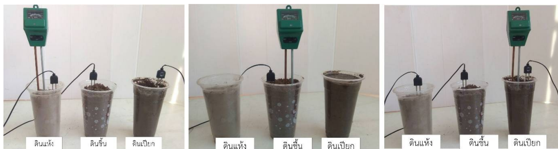
รูปที่ 8 การทดสอบวัดค่าความชื้นในดินแต่ละชนิด
