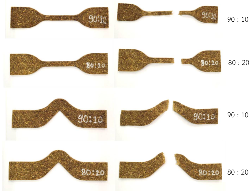
รูปที่ 1 วัสดุกันกระแทกจากยางพาราผสมต้นธูปฤๅษี อัตราส่วน 90 : 10 และอัตราส่วน 80 : 20 ก่อนและหลังการทดสอบ
