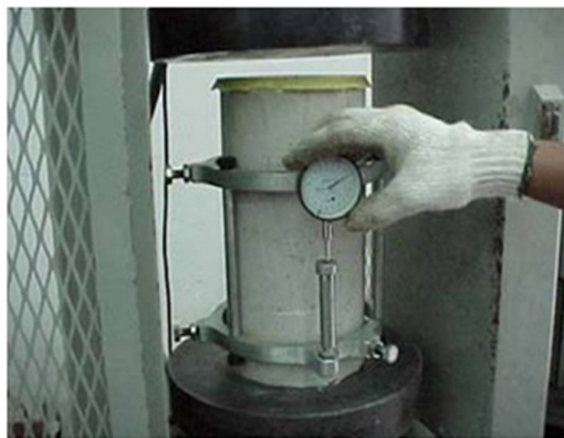
รูปที่ 3 การทดสอบทดสอบการรับกำลังอัดของคอนกรีต และโมดูลัสยืดหยุ่น
