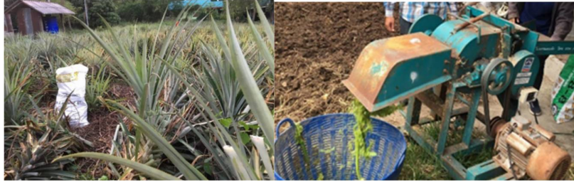
รูปที่ 1 ใบสับประรดและการปั่นใบสับประรดโดยใช้เครื่องสับหญ้าเนเปียร์
