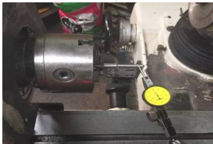
รูปที่ 2 เครื่องเจียระไนทรงกระบอกจับชิ้นงานด้วยหัวจับแบบสามจับ [แบบปัจจุบัน]
