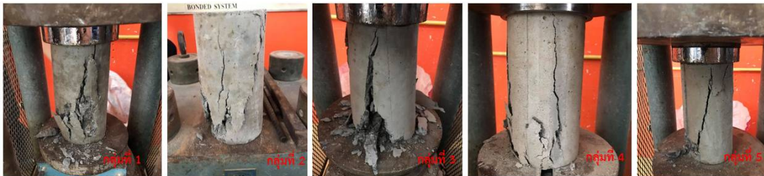
รูปที่ 2 การทดสอบเพื่อหาค่ากำลังรับแรงอัดเฉลี่ยของตัวอย่างคอนกรีตทั้ง 5 กลุ่ม
