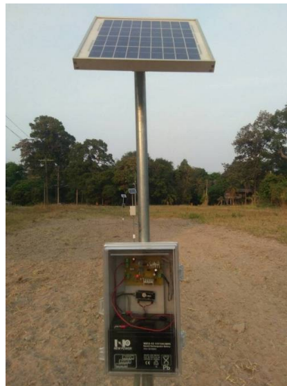
รูปที่ 9 อุปกรณ์ตรวจวัดค่าความชื้นในดินที่ใช้ทดสอบ
