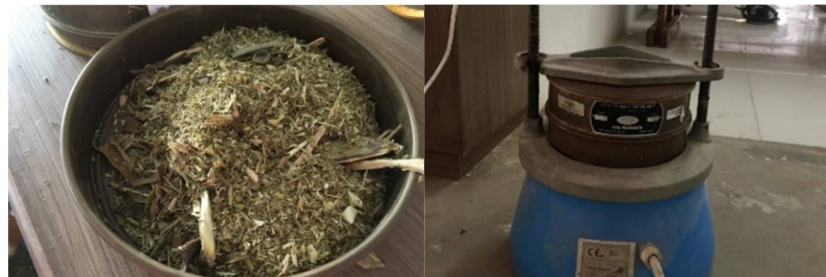
รูปที่ 3 นำไปร่อนผ่านตะแกรงเบอร์ 4 โดยเครื่องร่อน
