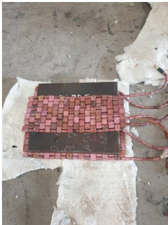
รูปที่ 6 รูปภาพชิ้นงานก่อนทำการอบ 610 C° นาน 1 ชั่วโมง
