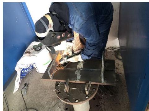
รูปที่ 4 รูปภาพแสดงวิธีการเชื่อมชิ้นงานในท่าราบ
