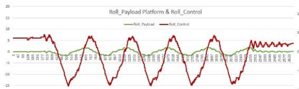
รูปที่ 10 แสดงกราฟของมุม Roll ( \phi )ของ Payload Platform เทียบกับค่าการควบคุมของเซอร์โวมอเตอร์
