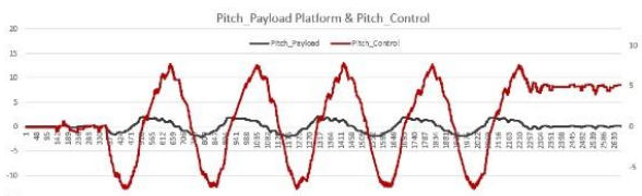
รูปที่ 11 แสดงกราฟของมุม Pitch ( \theta )ของ Payload Platform เทียบกับค่าการควบคุมของเซอร์โวมอเตอร์
