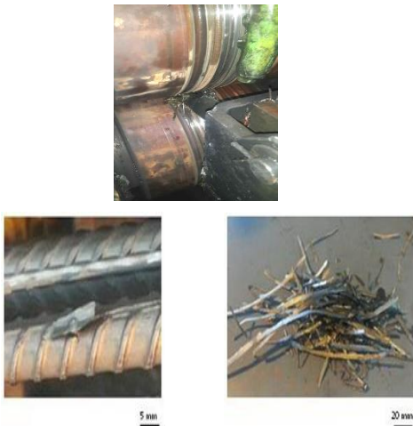
(รูปที่ 2 เหล็กข้ออ้อยที่เกิดรอยแตกขาว บริเวณพื้นผิวของเหล็กข้ออ้อยที่เกิดความเสียหายจะมีสีน้ำตาลแดง)
